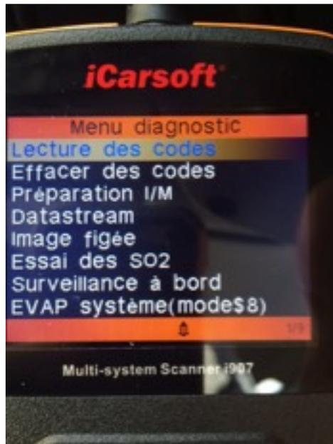
Une possibilité d'une lecture/effacement défaut est possible . Ceci est intéressant pour les véhicules OBDII .
