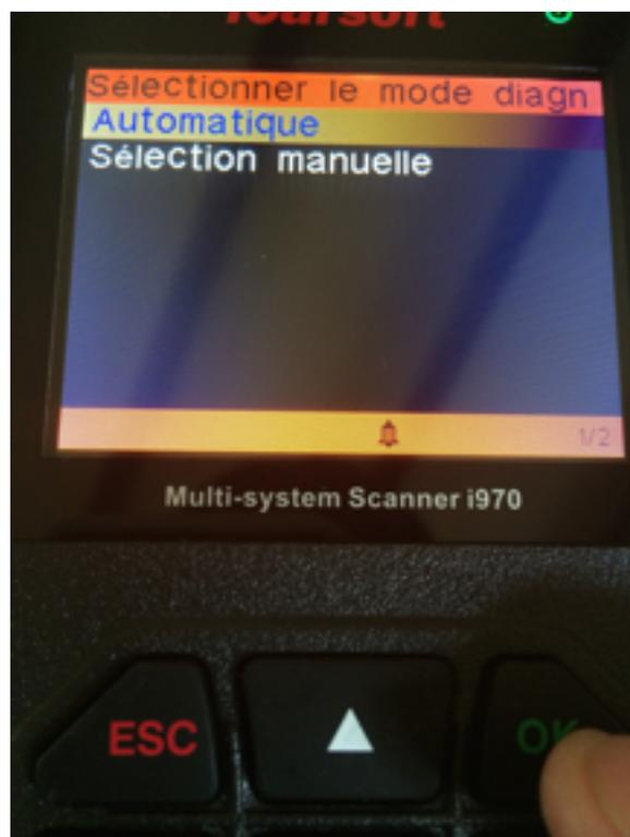
Le mode de sélection automatique permet à l'outil de scanner entièrement votre véhicules ainsi que tous les calculateurs possibles .
